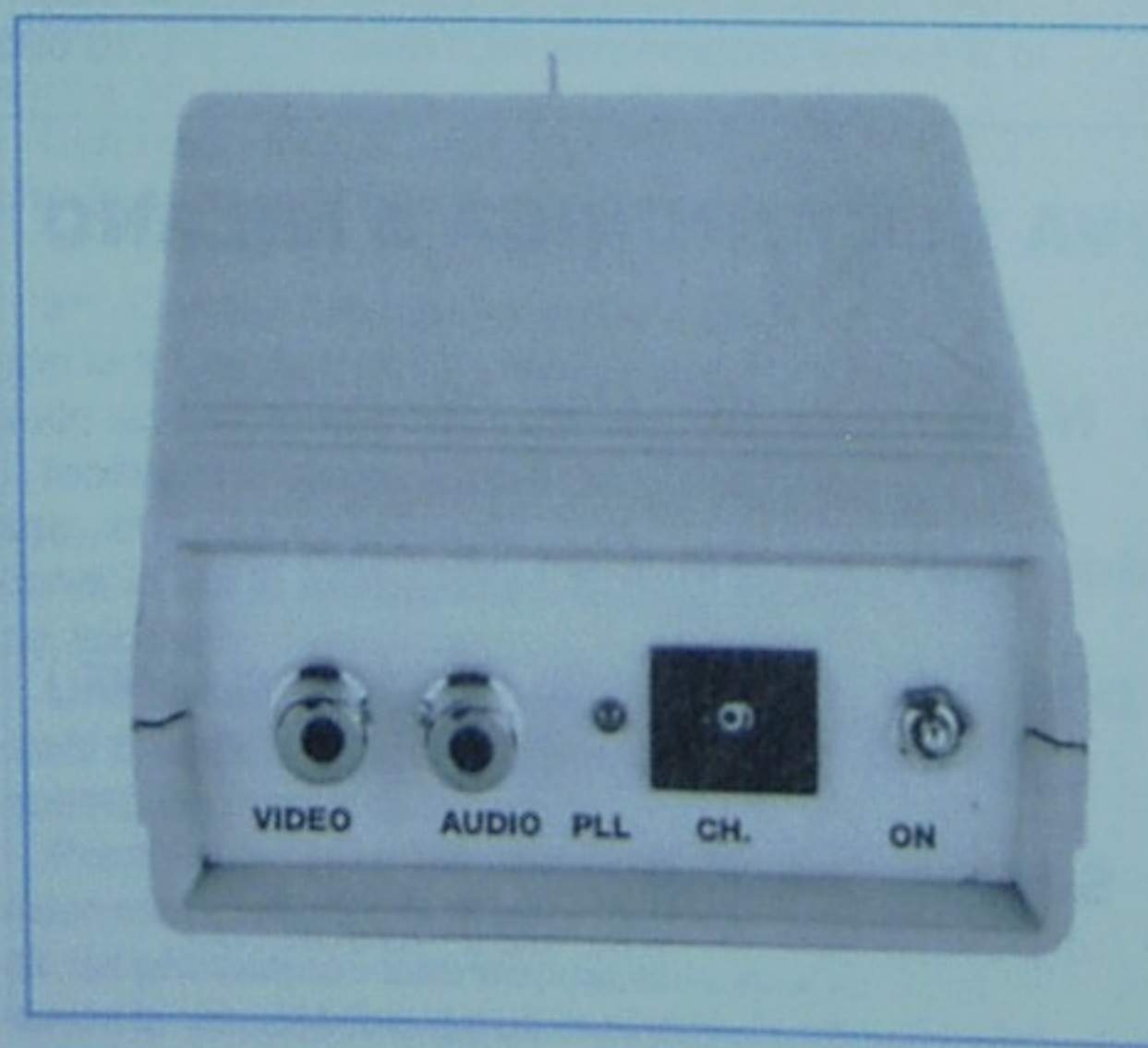
Fig.1 Sul pannello frontale del mobile sono presenti le due boccole d'ingresso per il segnale Audio-Video ed un commutatore binario per la scelta del Canale di trasmissione (vedi Tabella a pag.70). Come visibile nella foto di destra, questo progetto viene fornito completo di una piccola antenna a stilo.
